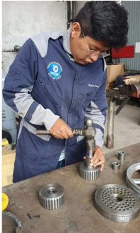
Figura 71. Colocación de rodillos con rodamientos en el eje secundario.
