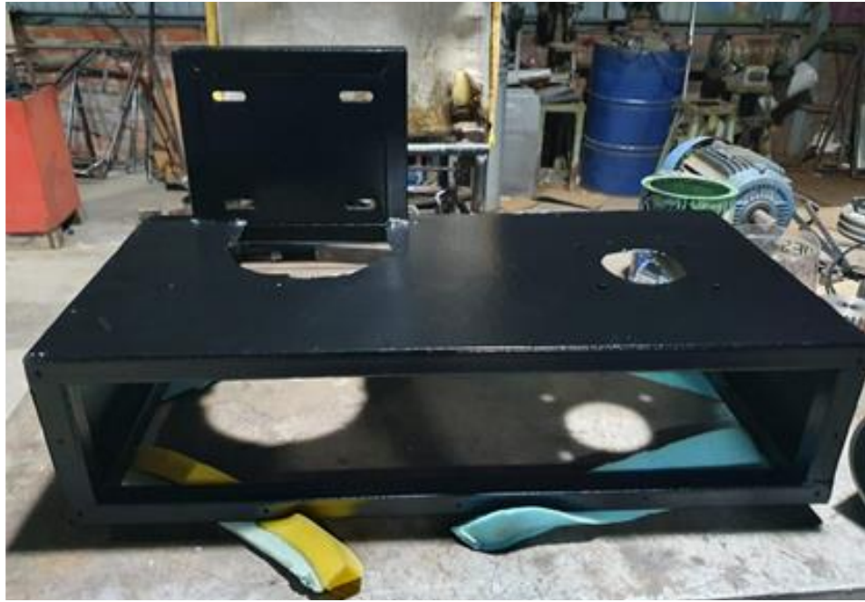
Figura 81. Pintado a horno de la estructura metálica.
