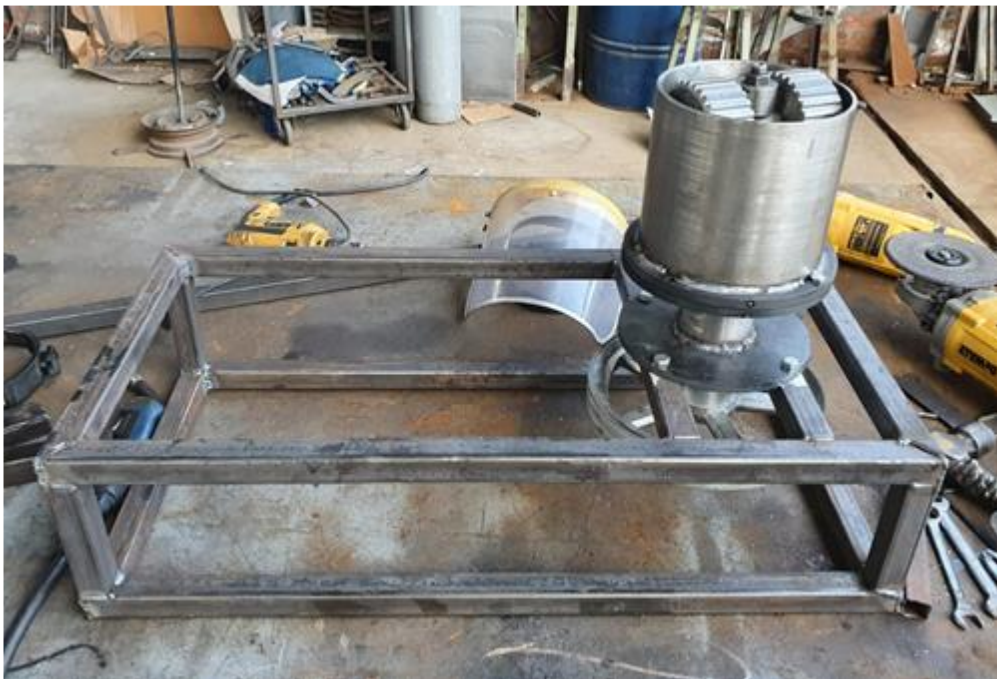
Figura 74. Montaje del mecanismo en la estructura metálica.
