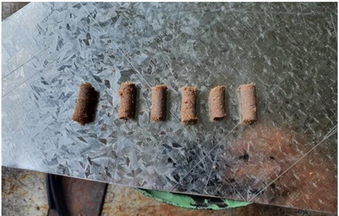
Figura 86. Muestra de pellets fabricados por la máquina.
