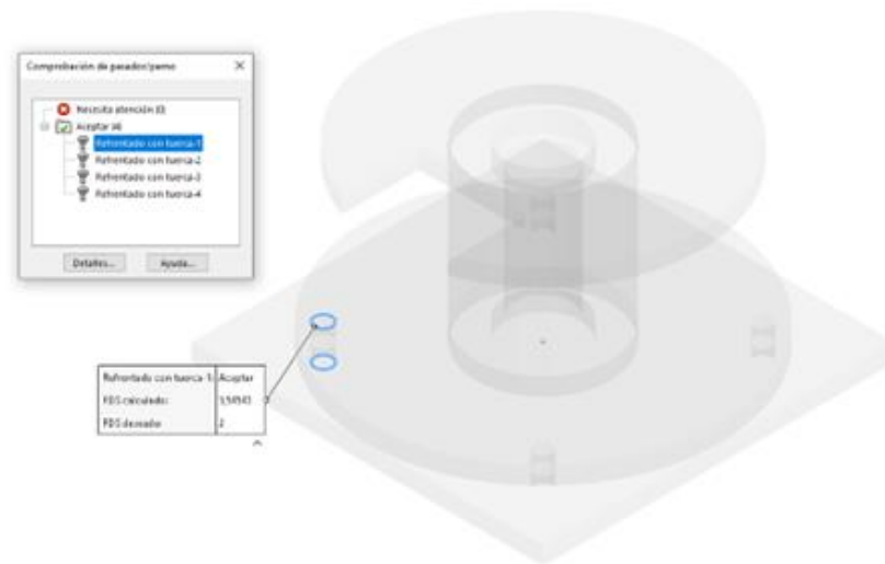
Figura 46. Factor de seguridad del primer perno.
