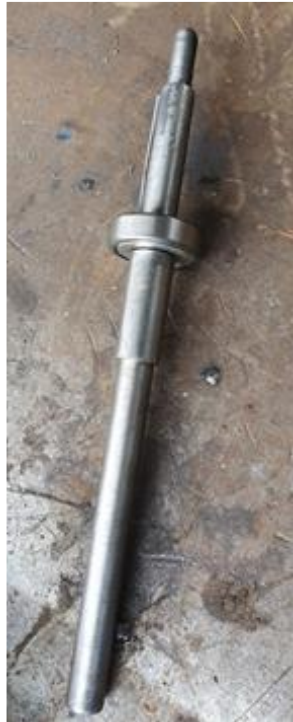
Figura 51. Eje principal mecanizado.
