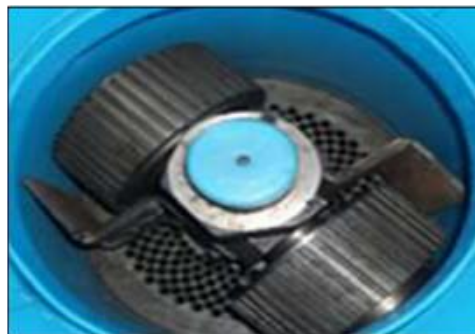
Figura 10. Peletizadora de matriz plana estática con rodillos giratorios. [27]
