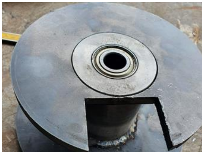
Figura 56. Placas circulares del soporte.
