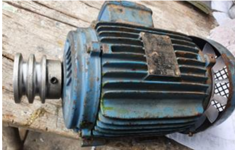
Figura 65. Polea motriz y motor eléctrico.
