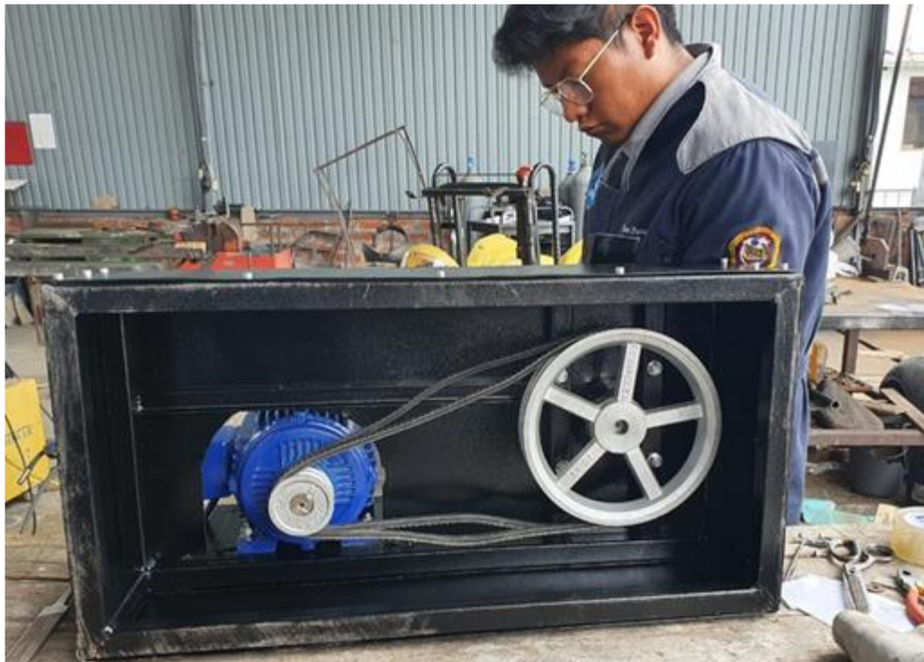
Figura 84. Ajustes de bandas tipo A.
