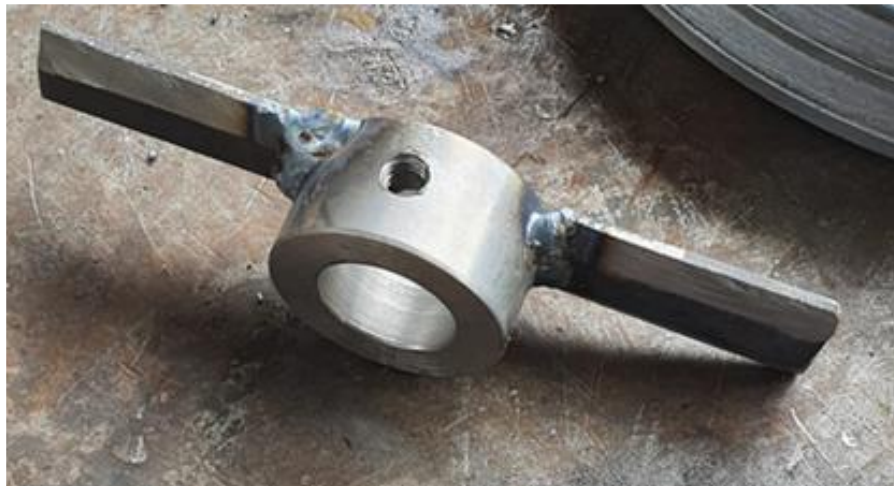
Figura 64. Cuchillas de corte construidas.
