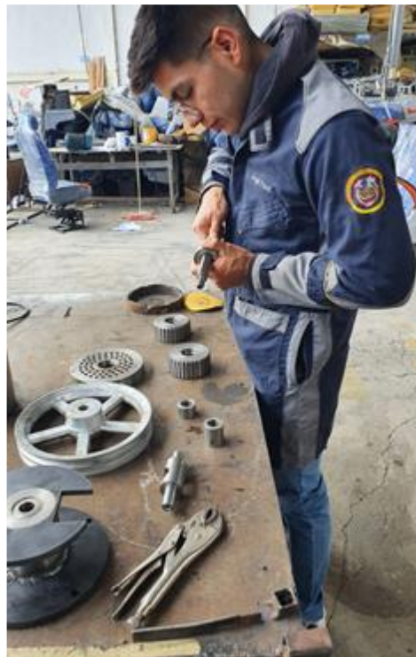
Figura 72. Colocación de rodamientos en el eje principal.
