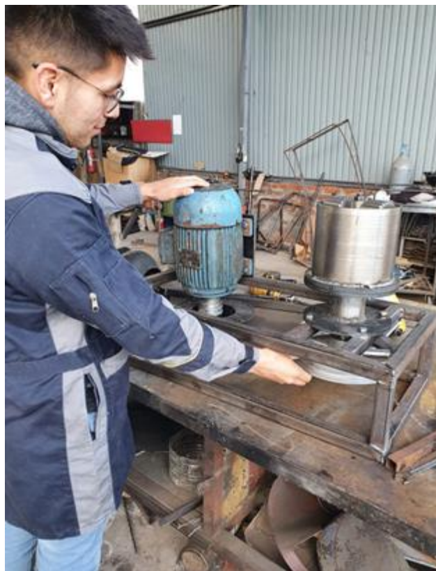
Figura 76. Nivelación de las poleas.
