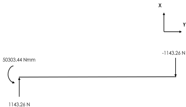
Figura 32. Reacciones obtenidas en el eje secundario.
