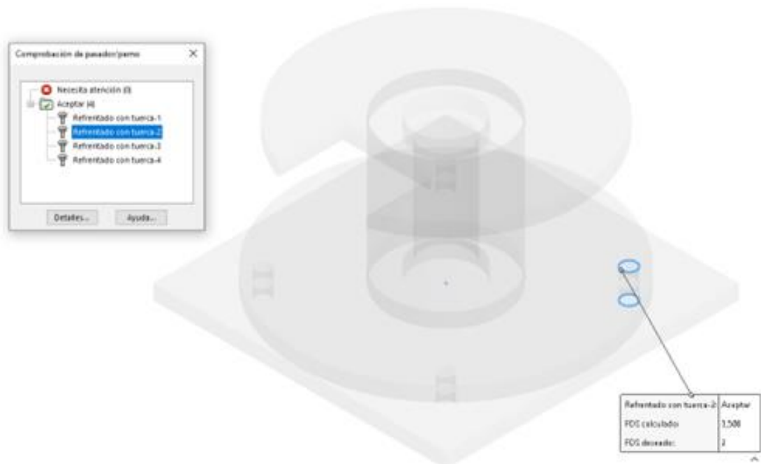
Figura 46. Factor de seguridad del primer perno.
