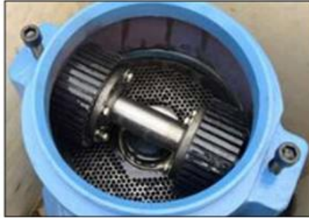
Figura 11. Peletizadora de matriz plana giratoria con rodillos estáticos. [27]
