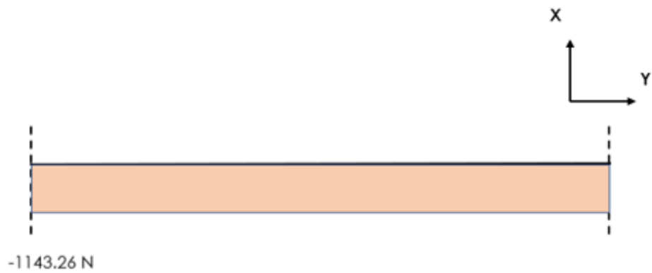
Figura 33. Diagrama de fuerza cortante del eje secundario.
