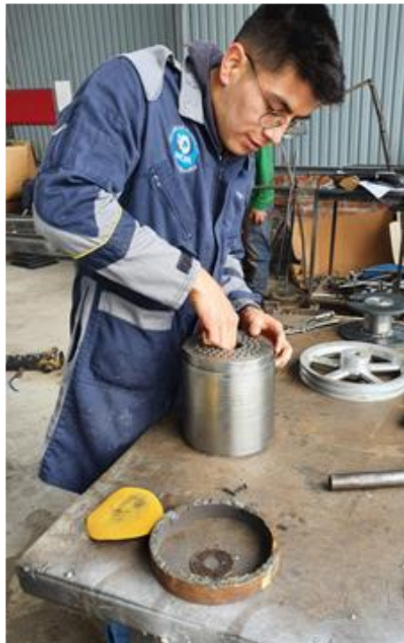
Figura 70. Colocación de la matriz en el cubo.
