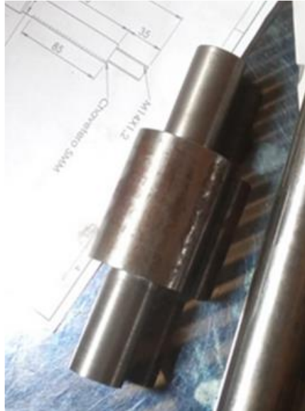
Figura 53. Eje de acero AISI SAE 1018.
