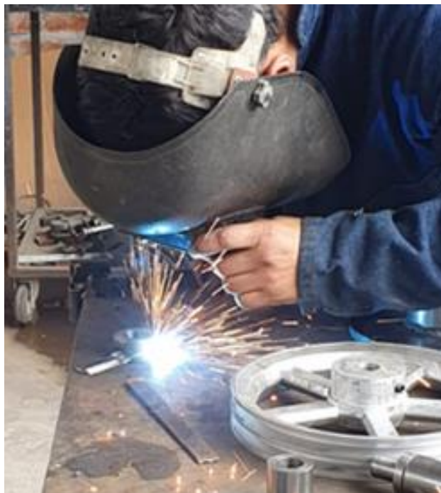
Figura 68. Proceso de soldadura de las cuchillas.
