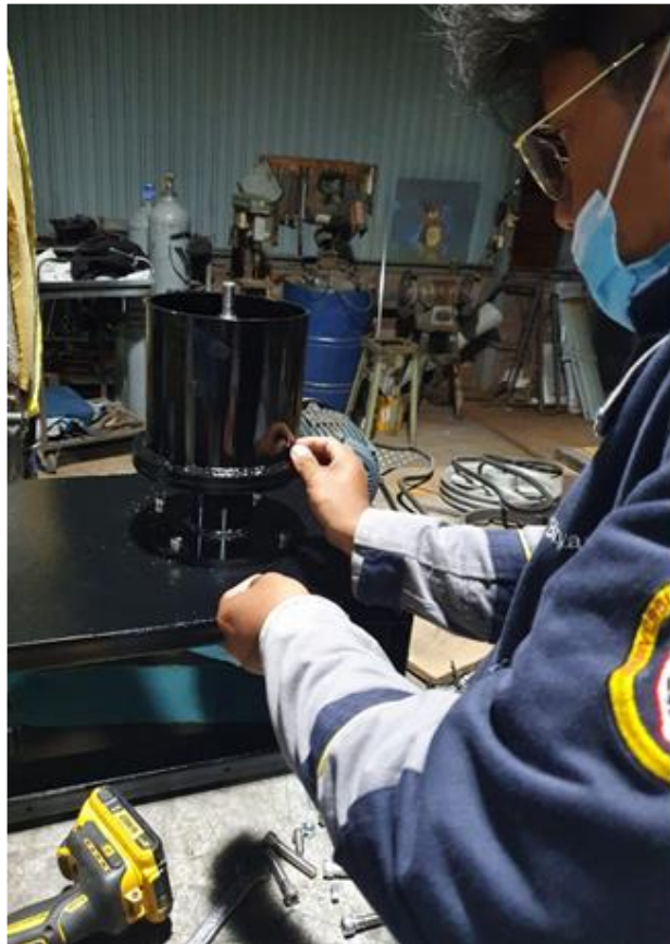
Figura 82. Fijación de partes por pernos.
