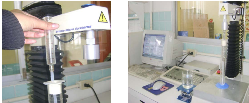
Figura 15. Secuencia de medición en el equipo universal TA-XT2i.
