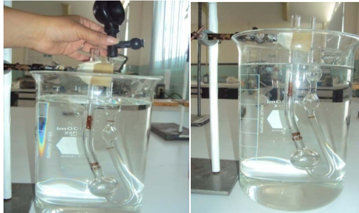
Figura 13. Recorrido del agua a través del viscosímetro del tubo capilar Cannon-Fenske
