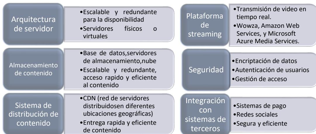
**Figura 9.** Diseño de la arquitectura de una plataforma OTT [39].
