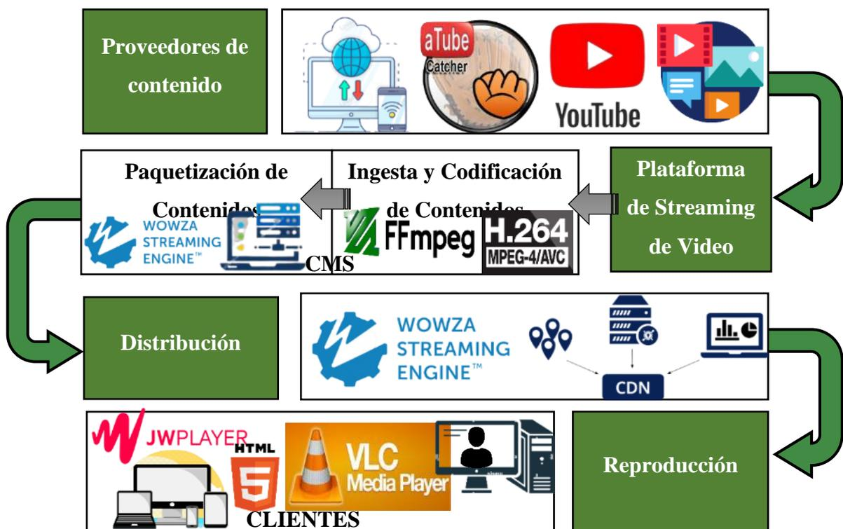
**Figura 18.** Diagrama de bloques de la plataforma OTT
