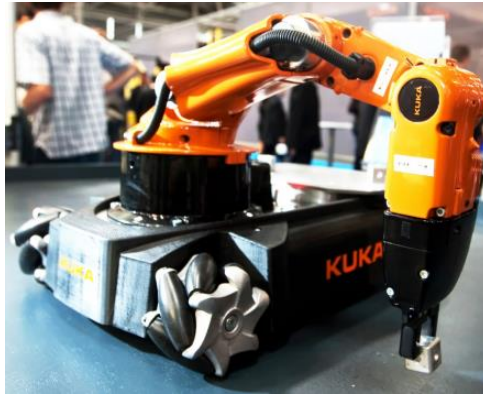
Figura 1. Robot omnidireccional autónomo KUKA youBot [12].
