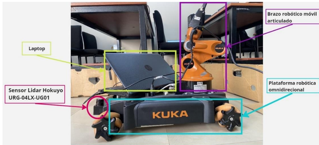
Figura 29. Robot KUKA youBot real simulado con sensor lidar Hokuyo.
