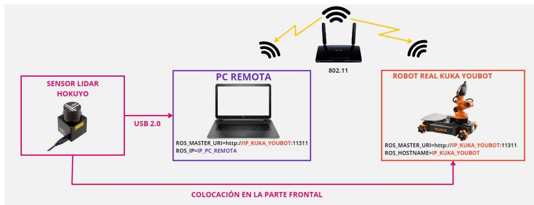
Figura 19. Esquema de conexión sensor lidar Hokuyo y KUKA YouBot real.
