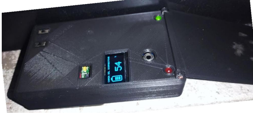
Figura 73: Dispositivo de medición de signos vitales en funcionamiento
