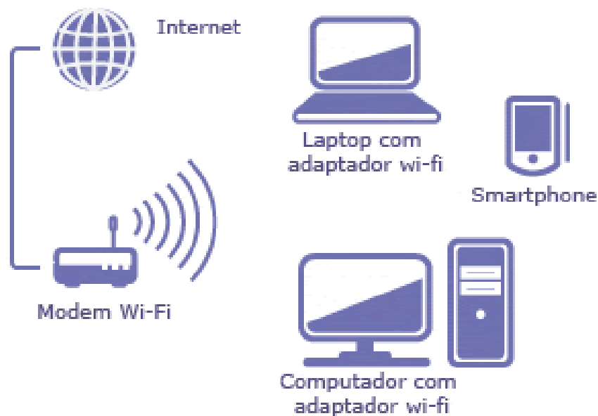
Figura 8 Componentes de una red WIFI
