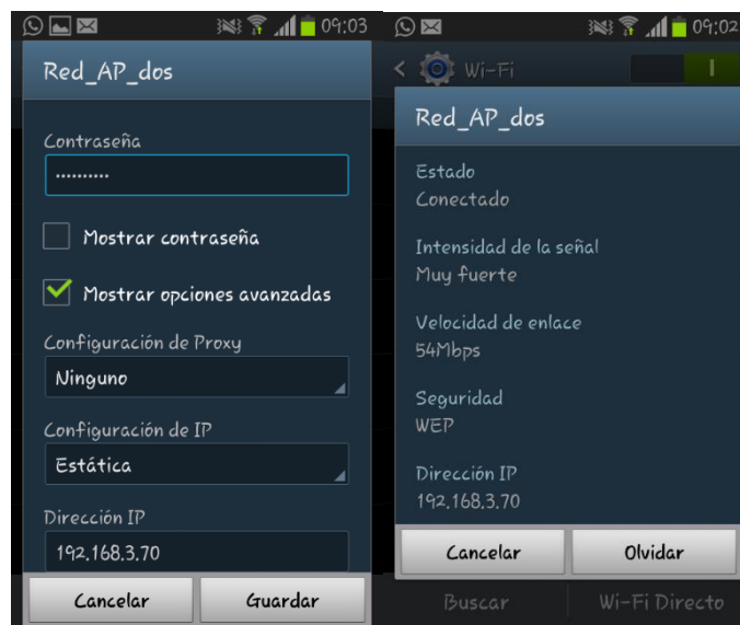
Figura 28. Configuración de los parámetros de red del smartphone para la conexión con el AP2.
