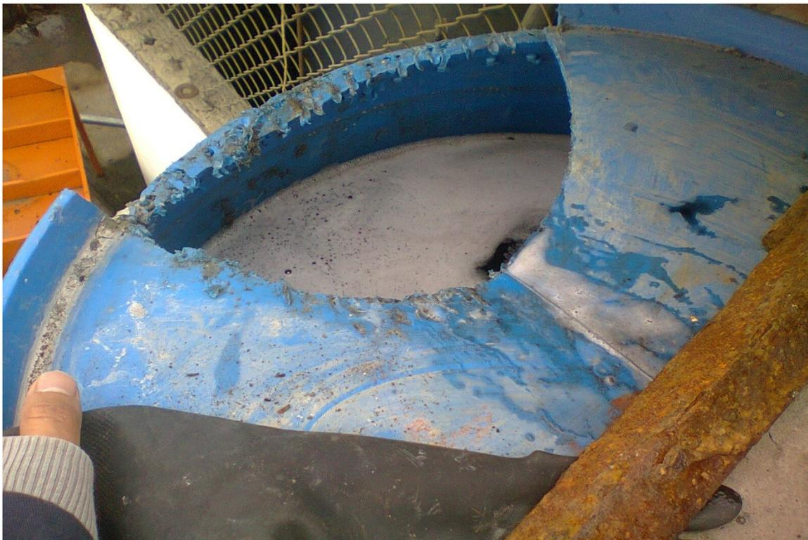
Fotografía 10: Tanque de abastecimiento lleno efluente de pelambre
