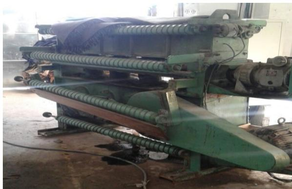
**Figura 10.** Proceso Acondicionamiento y Secado Etapa Mollizado
