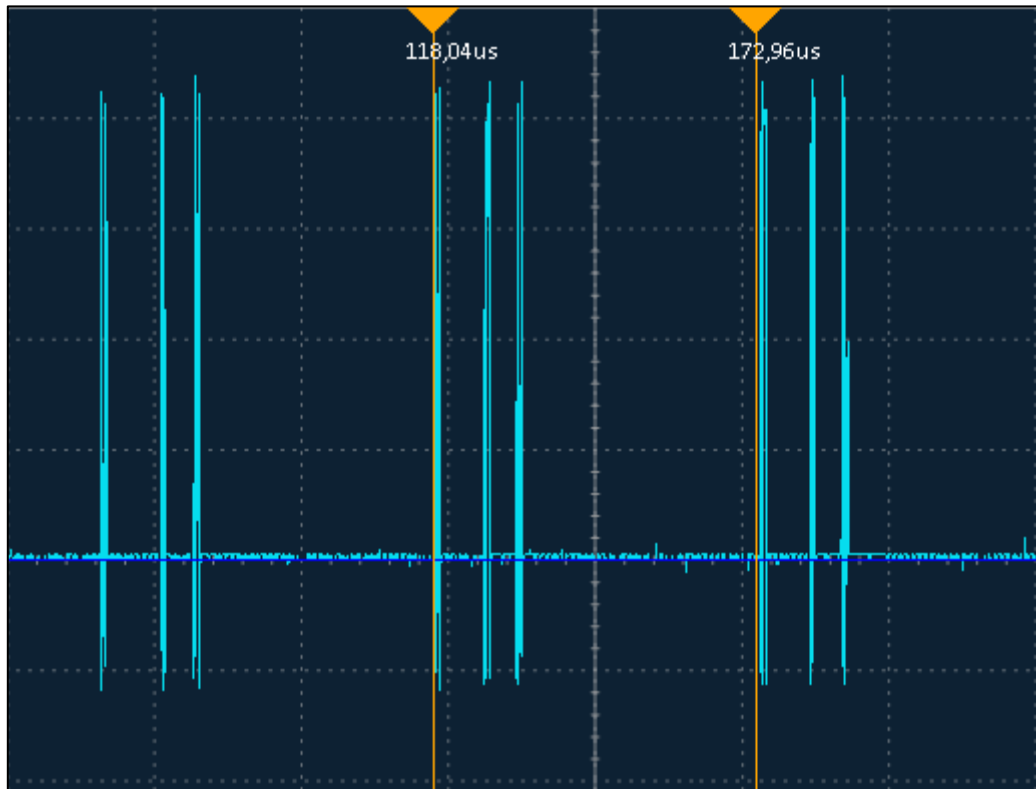
Figura 4.15 Transmisión de las señales de reloj en una comunicación normal.
