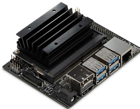
Figura 8. NVIDIA Jetson Nano. [42]
