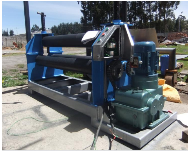
IMAGEN 6.7.11. Instalación del Motoreductor
