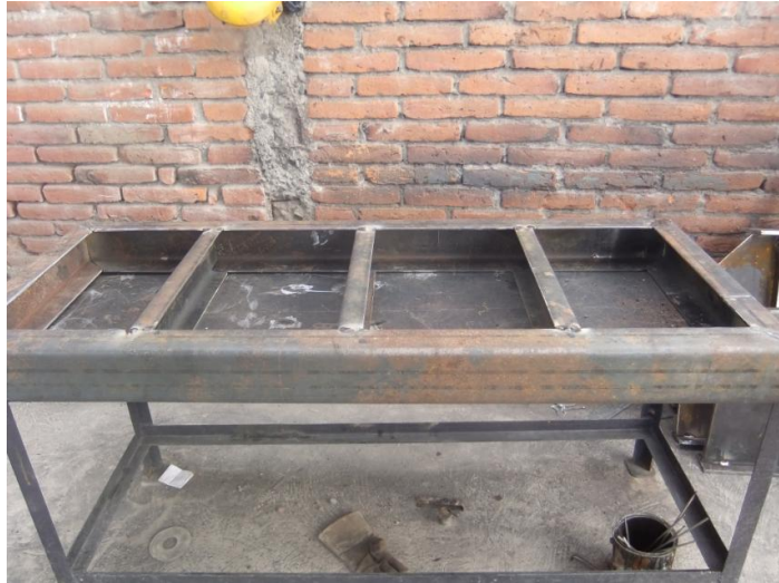
IMAGEN. 6.7.1 Estructura o mesa de soporte
