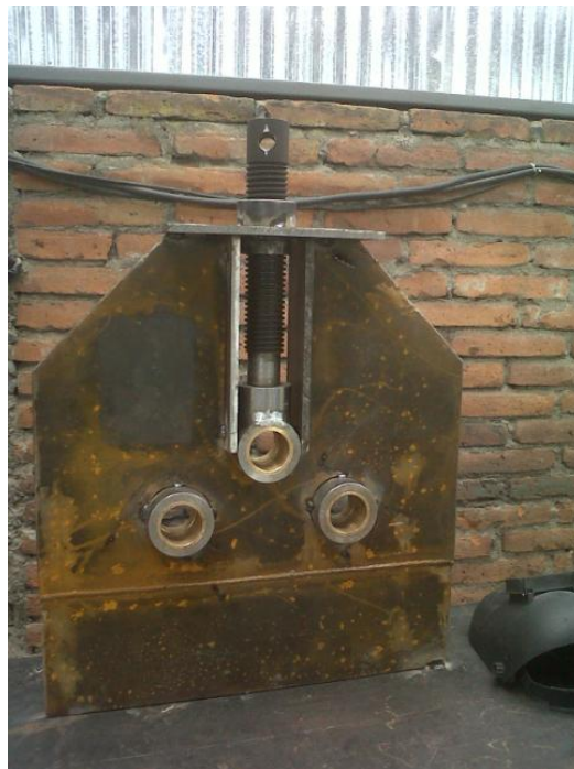
IMAGEN 6.7.3. Montaje de la placa lateral izquierda sobre la mesa mediante sujetadores roscados.
