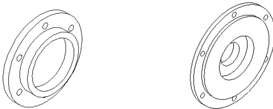
Gráfico 6.13. Caja reductora. Izquierda tapa posterior. Derecha tapa frontal y lateral de caja
