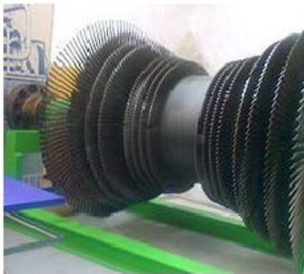
Gráfico 30: Turbina de una central termoeléctrica.
