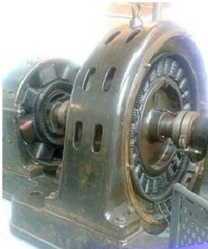
Gráfico 29: Alternador de fábrica textil (Museo de la Ciencia y de la Técnica de Cataluña, Tarrasa).
