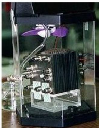
Gráfico 35: Pila de hidrógeno. La celda en sí es la estructura cúbica del centro de la imagen.
