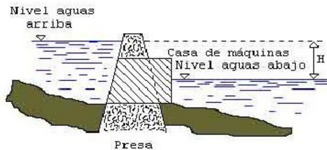
Gráfico 34: Esquema General de una Central Hidroeléctrica Pasada
