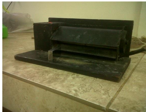
Figura 6-10 Lavado y secado probetas para el Ensayo Metalográfico
