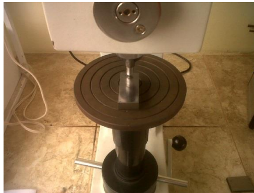
Figura 6-15 Colocación de la probeta en el Durómetro
