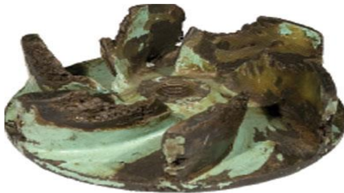
Figura 2-12 Desgaste por cavitación
