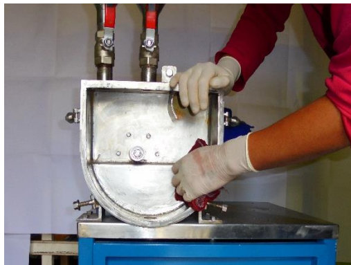
Figura 6-23 Limpieza de la cámara de mezcla del abrasivo.
