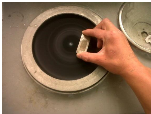
Figura 6-8 Pulido de la superficie de las probetas para el Ensayo Metalográfico
