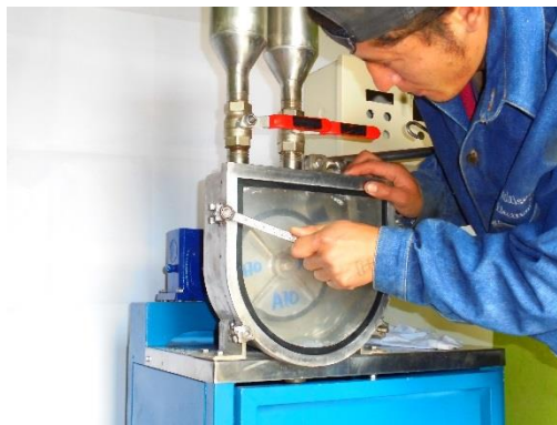
Figura 6-29 Colocación de la arena sílica y agua.
