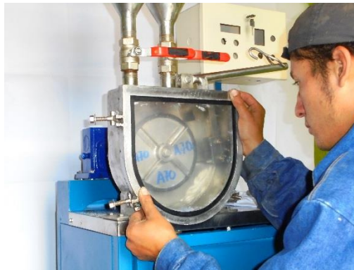
Figura 6-28 Colocación de la cubierta de policarbonato.
