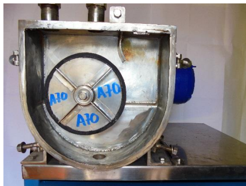
Figura 6-24 Colocación del disco de neopreno.
