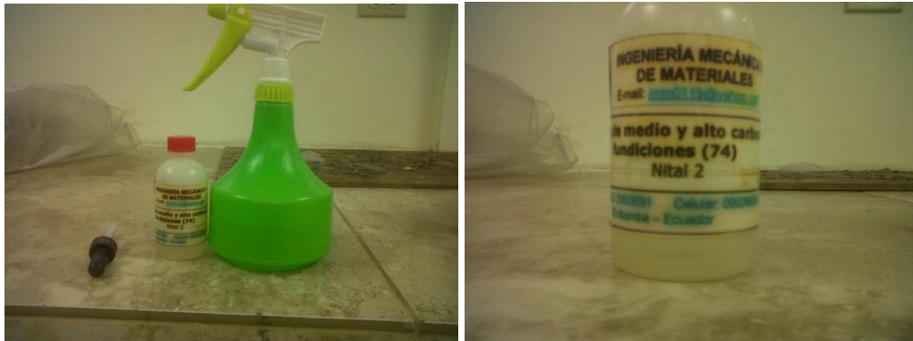
Figura 6-11 Químicos utilizados en el Ensayo Metalográfico (Nital 2%)
