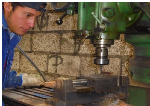
Figura 6-2 Probeta fresada para dar las dimensiones requeridas.
