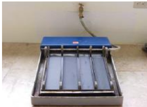
Figura 6-14 Lijado de las probetas para el Ensayo de Dureza
