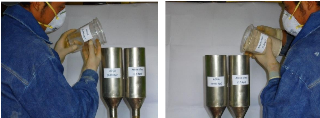
Figura 6-26 Colocación de la arena sílica y agua.
