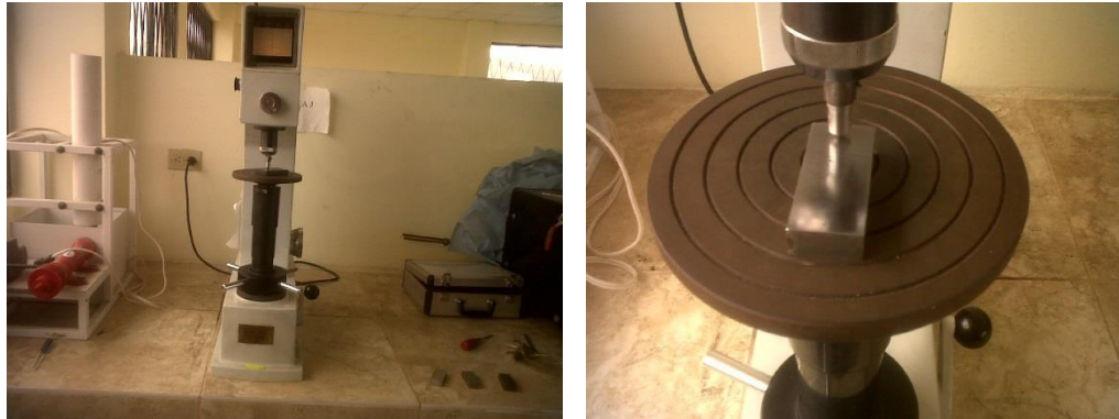
Figura 6-16 Ejecución del Ensayo de Dureza
