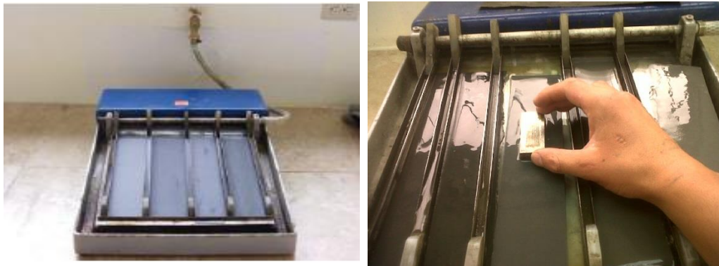
Figura 6-7 Lijado de las probetas para el Ensayo Metalográfico
