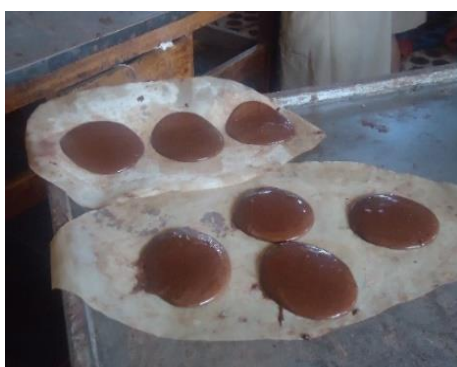
Figura 4.12 Compactación de tabletas manualmente
