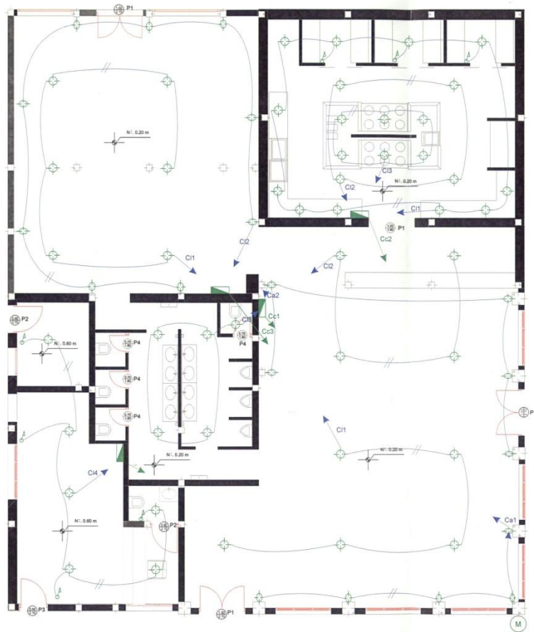
Esc. 1:100 -----PLANTA INSTALACIONES ELECTRICAS
