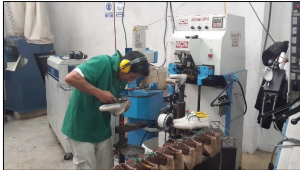
Figura 19. Área de trabajo: Armado de talones y laterales
