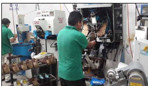
Figura 18. Área de trabajo: Armado de puntas
