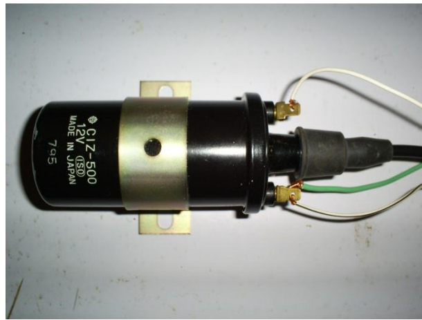
Figura # 20. Bobina de transformación Elaborado por: Carrillo D.
