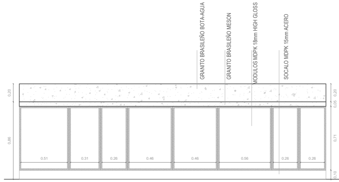
MODULOS TABLERO LAMINADO COLOR BLANCO ESCALA 1:20
