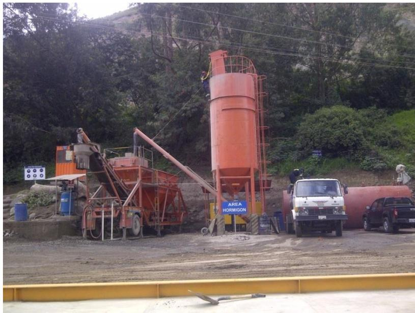
**Fig. 9:** Proceso de preparación de hormigón
