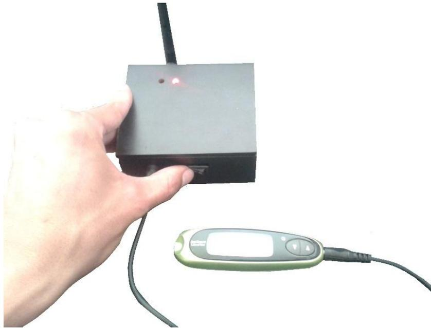
5. Una vez que la luz roja se ha encendido, espere alrededor de 10 segundos, deberá aparecer la palabra "PC" en la pantalla de su glucómetro, esto le indicará que la conexión ha sido exitosa y que la medición será enviada.
