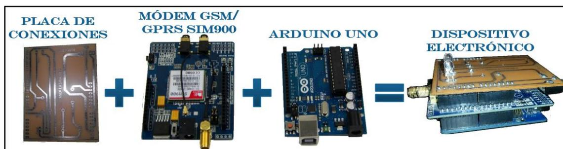
Fig. 4.30. Componentes del Dispositivo Electrónico del Entorno del Paciente
