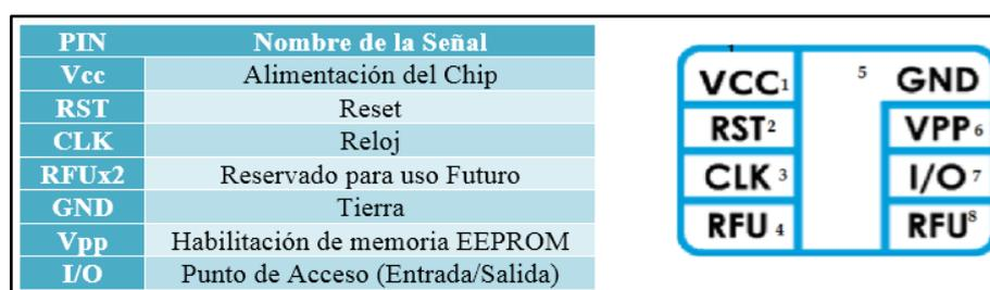
**Fig. 4.15. Esquema de pines de una tarjeta SIM**
