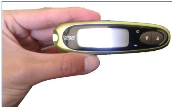
3. Conecte el glucómetro al dispositivo electrónico del sistema de Telemedicina, usando el cable de datos que viene junto a su sistema. El puerto de datos se encuentra en la parte inferior.
