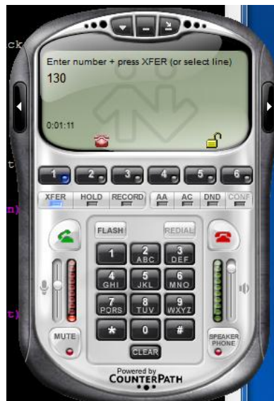
Figura 100 Transferencia de llamada desde Softphone.
