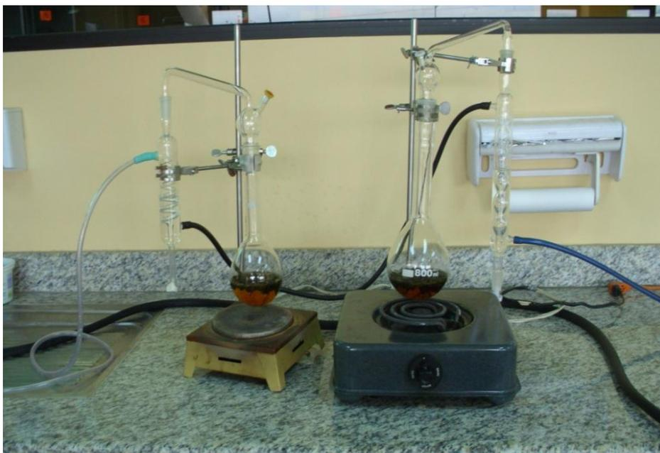
**Fotografía 1.** Equipo Kjeldahl utilizado para el proceso de destilación.
