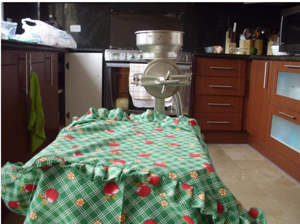
**Fotografía E-4. Molino acoplado para el triturado.**
