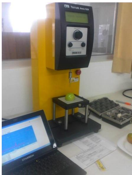
**Foto 25.** Análisis de Dureza texturómetro Brookfield CT3
