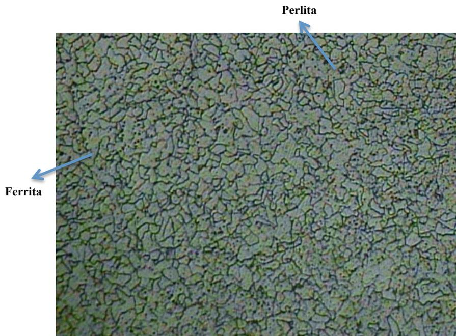
Acero ASTM A 36 como viene de fábrica (100X, Nital 4, 5s)
