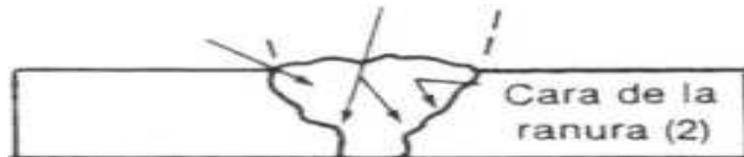
**Figura 2.5 Soldadura de ranura en corte transversal**
