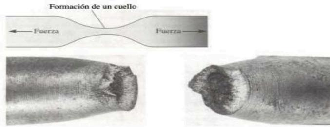
**Figura 2.34** Deformación localizada de un material dúctil durante un ensayo de tensión; se produce una región de cuello; En la fotografía se observa la parte del cuello en una muestra fracturada
