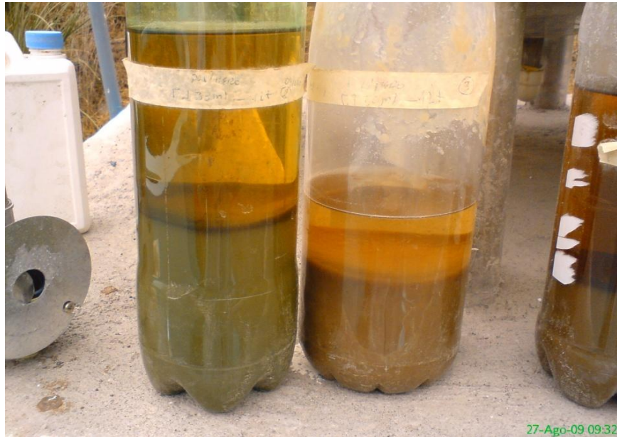
Imagen 36. Dosificación con policloruro de aluminio.
