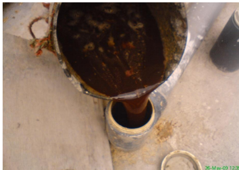
Imagen 18. Colocación del efluente del camal en el interior del UASB
