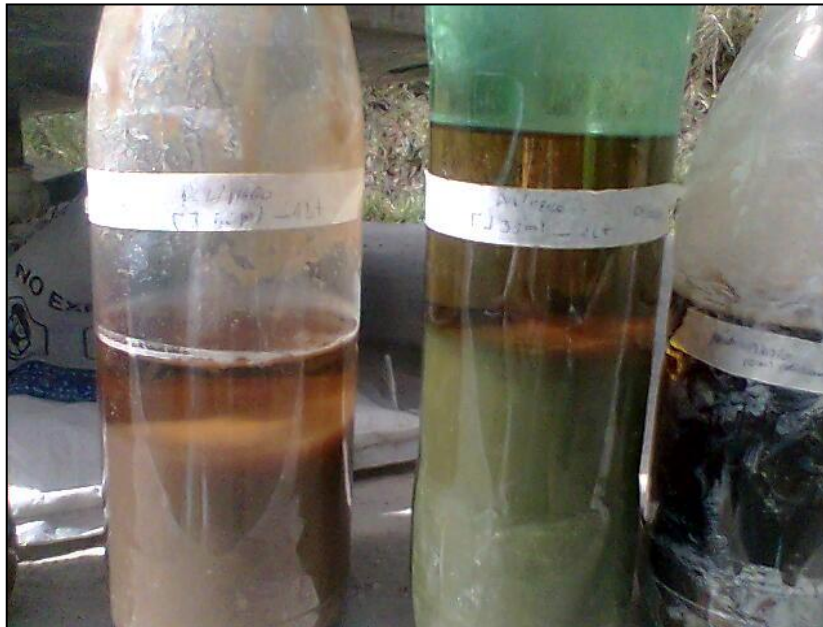
Imagen 35. Dosificación realizada con polímero (mayor clarificación)
