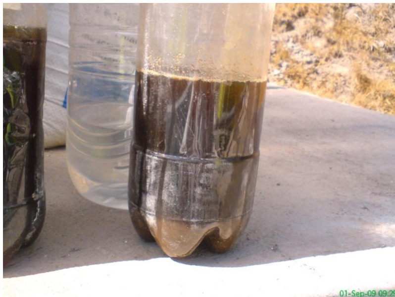
Imagen 37. Dosificación con mayores concentraciones de sulfato
