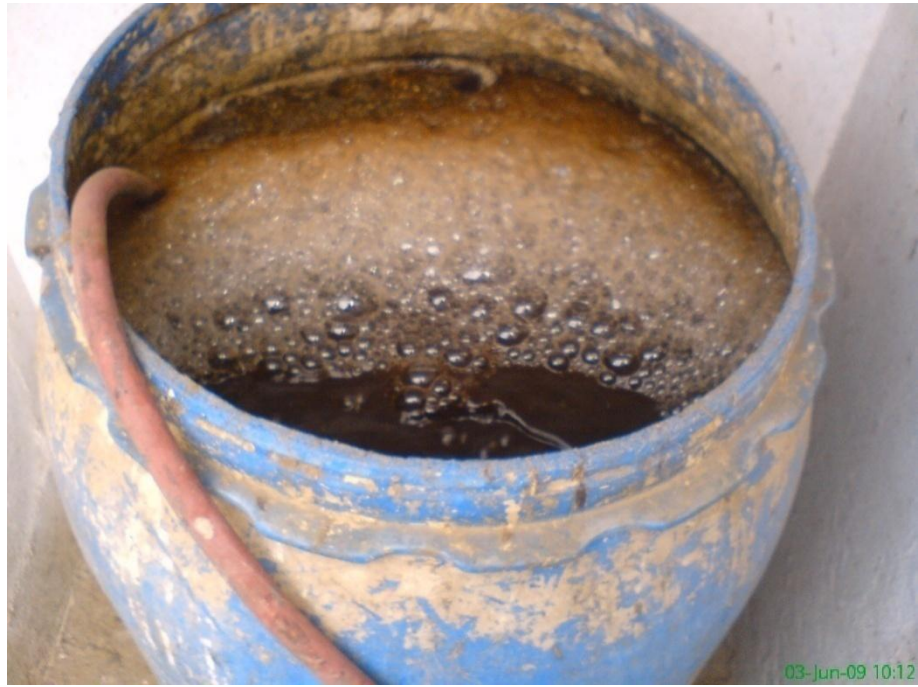
Imagen 21. Oxigenación del efluente del camal mediante un compresor.
