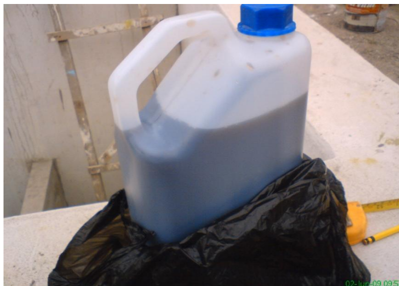
Imagen 20. Muestra de lixiviado recogido de las diferentes alturas del digester UASB
