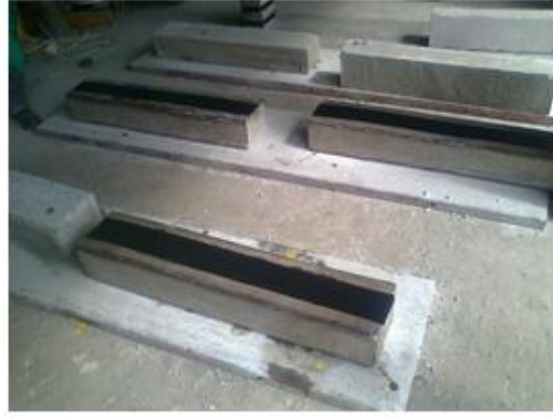
COLOCACIÓN DEL REFORZAMIENTO CFRP, PROCESO DE FRAGUADO DE LA RESINA
