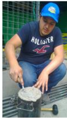
MUESTRAS PARA ENSAYOS DE RESISTENCIA DEL HORMIGÓN
