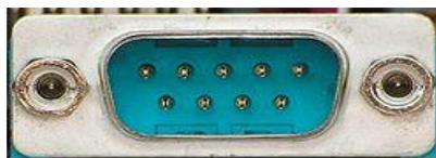
**Figura 6.5:** Conector DB9 utilizado en el puerto serie. [14]
