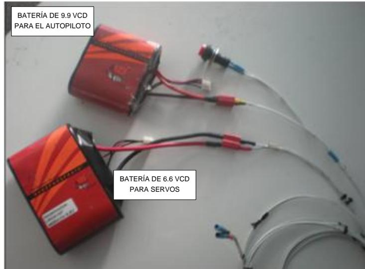
Baterías de 9.9 y 6.6 voltios de corriente para la alimentación del autopiloto y servos de control
