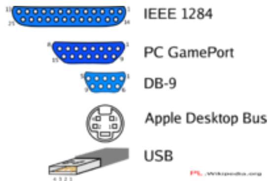
**Figura 2.3:** Conectores usados en Joysticks. [3]
