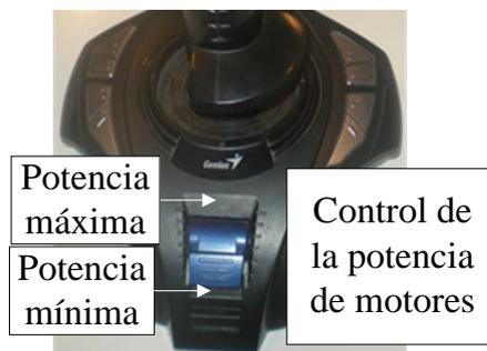
**Figura 6.44:** Control de motores de propulsión.
