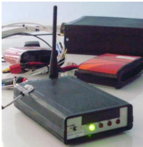
Radio modem XBEE PRO dentro de su caja de protección.
