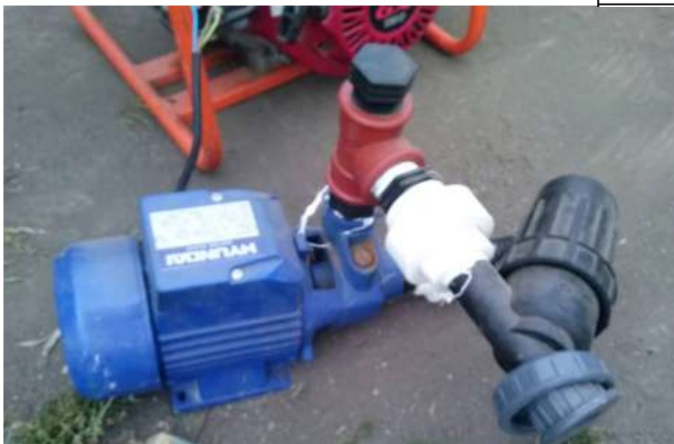
Bomba de agua
