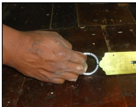
Fig. 9. Sujetar el aro de metal del dinamómetro
