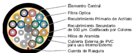
Figura 2.13 Composición interna del cable Fibra Óptica [12]
