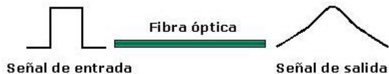
Figura 6.1 Pérdida por dispersión en la Fibra Óptica [16]
