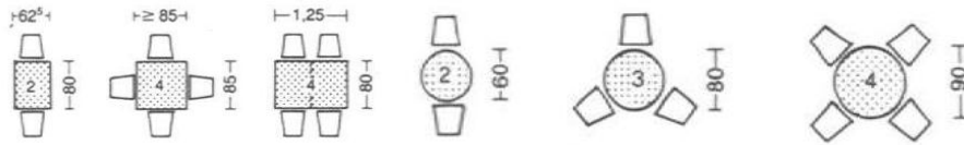
Fig. 57: Dimensiones de mesas Disponible en: Arte de proyectar. (14a ed.). Neufert, Ernst. (1992).
