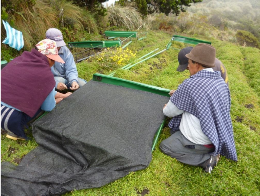
Cocido de la malla de sarán en el marco del colector de evaluación.
