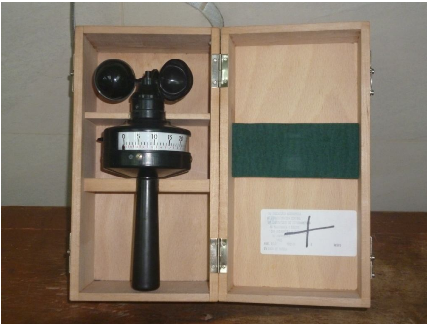
Anemómetro, utilizado en la medición de la velocidad del viento.
