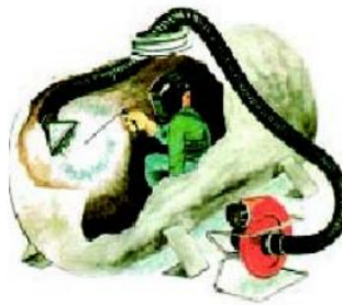
Ventilación por extracción localizada
