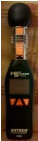
**Foto 27:** Medidor WBGT marca EXTECH INSTRUMENT
