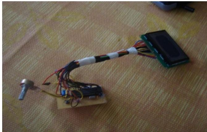
Figura 6.45. Circuito en baquelita del GLCD.
