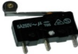
Figura 2.22. Sensor de contacto de fin de carrera.
