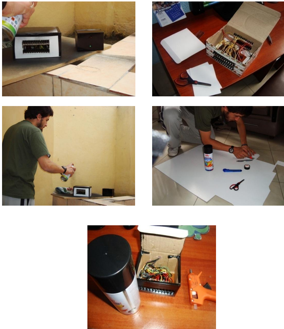
Figuras 7.8. Arreglo de los circuitos en caja y pintura de cada uno.
