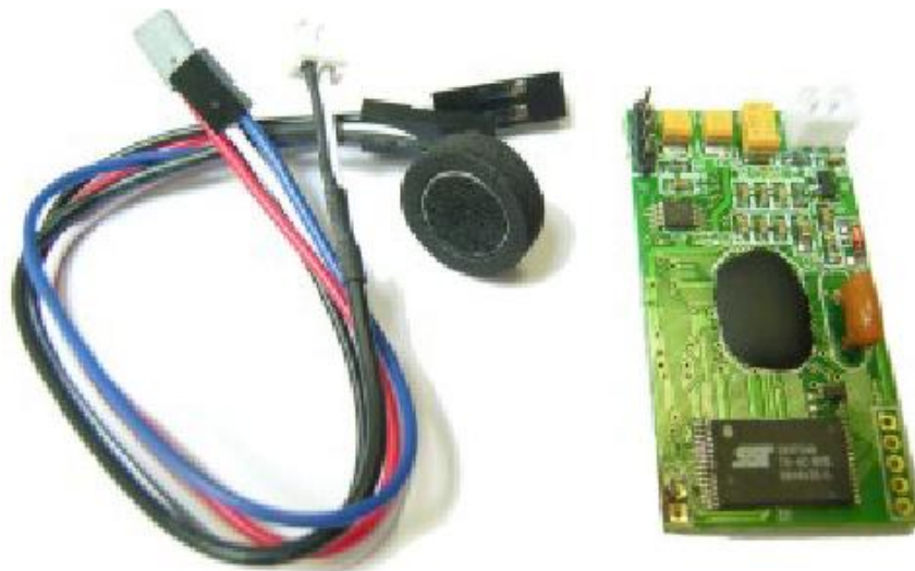
Figura 6.66. Interfaz para comunicación VRbot con el robot.
