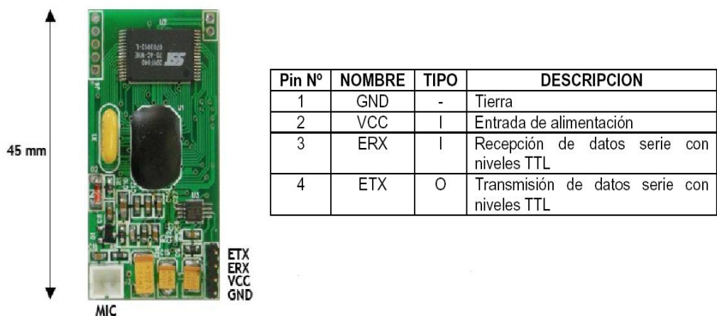
Figura 6.67. Dimensiones físicas del módulo VRbot.
