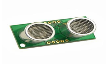
Figura 2.11. Sensor externo SRF-05 con ultrasonido capaz de medir distancias.
