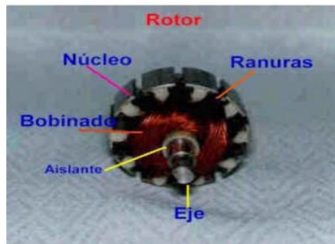
Figura 6.17. Representación de un rotor en motor DC.
