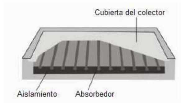
FIGURA 2-5 Colector Solar Térmico de Placa Plana
