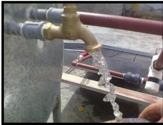
FIGURA 6-5 Salida del agua del panel a la temperatura deseada al final del ensayo.
