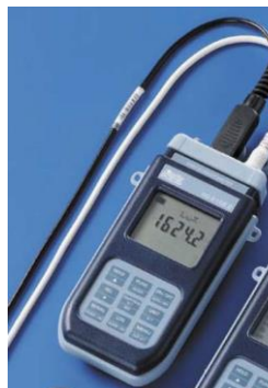
FIGURA 3-1 Foto-radiómetro Delta OHM modelo HD 2102.2
