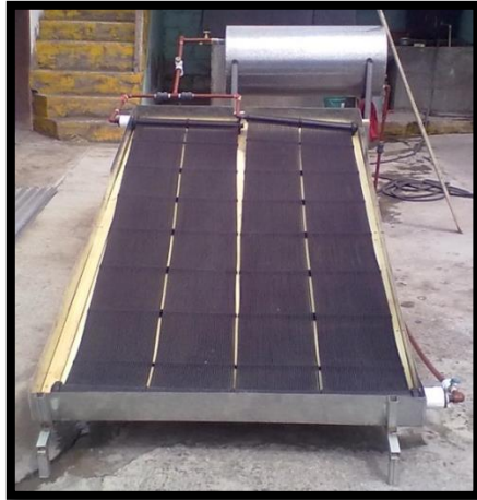
FIGURA 6-4 Calentador solar de tubos de polipropileno
