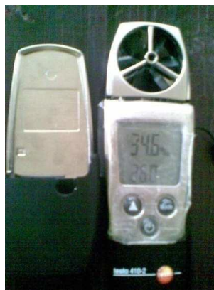
FIGURA 3-3 Anemómetro Digital Testo 410-2
