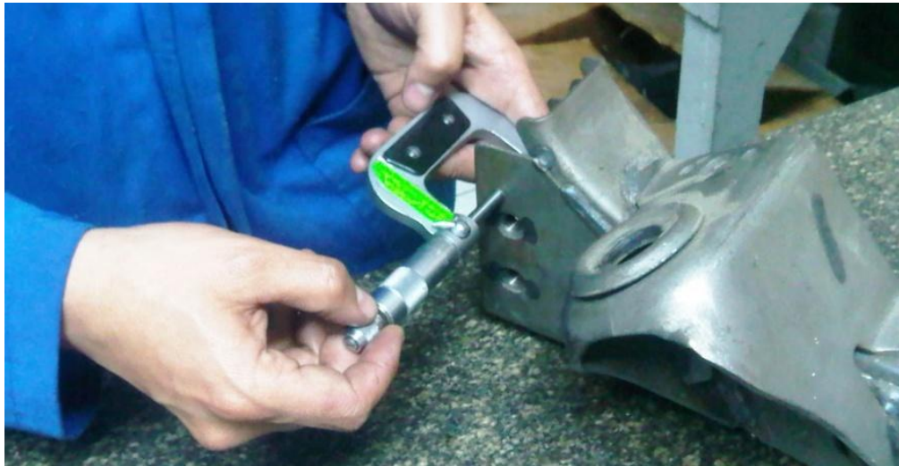
Gráfico 32: Comprobación de espesores con micrómetro analógico Fuente: Ecuamatríz Cía. Ltda.
