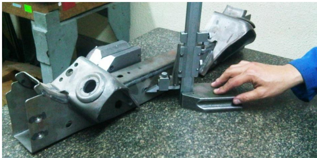
Gráfico 30: Posicionamiento de perforaciones con Altimetro analógico Fuente: Ecuamatríz Cía. Ltda.
