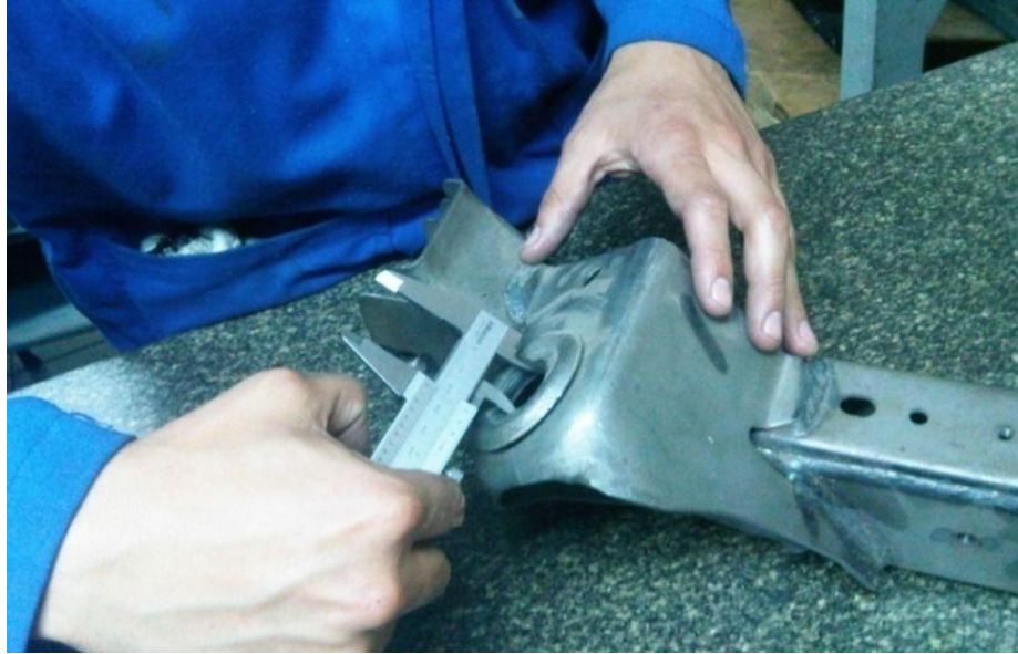
Gráfico 31: Verificación de diámetros con calibrador analógico Fuente: Ecuamatríz Cía. Ltda.
