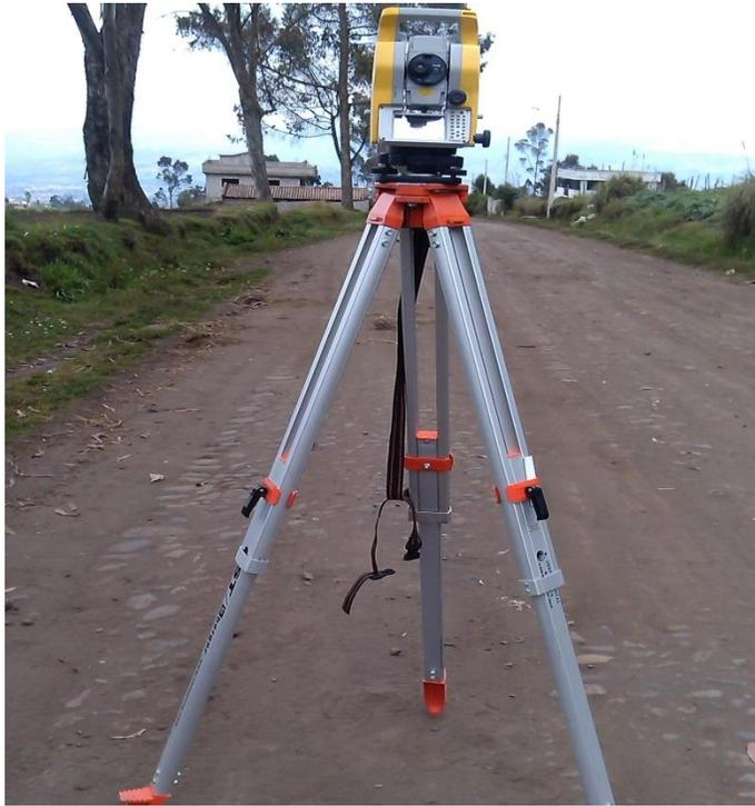
**Fotografía 5.- Equipo topográfico para replanteo de la red de conducción de agua**
