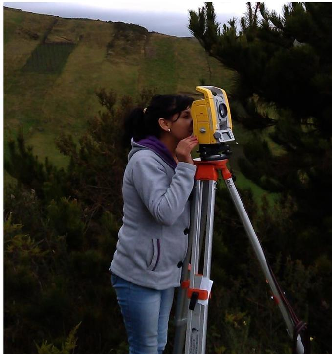
**Fotografía 6.- Manejo de estación total (Trimble)**
