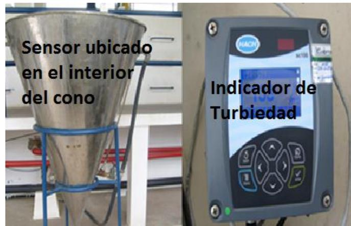
**Ilustración 31:** Medidor e indicador de Turbiedad
