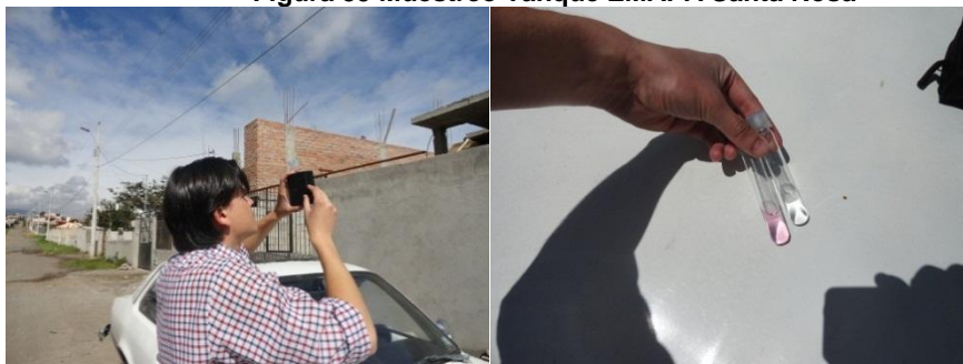
Figura 60 y 61 Medición del Nivel de Cloro Residual con DPD
