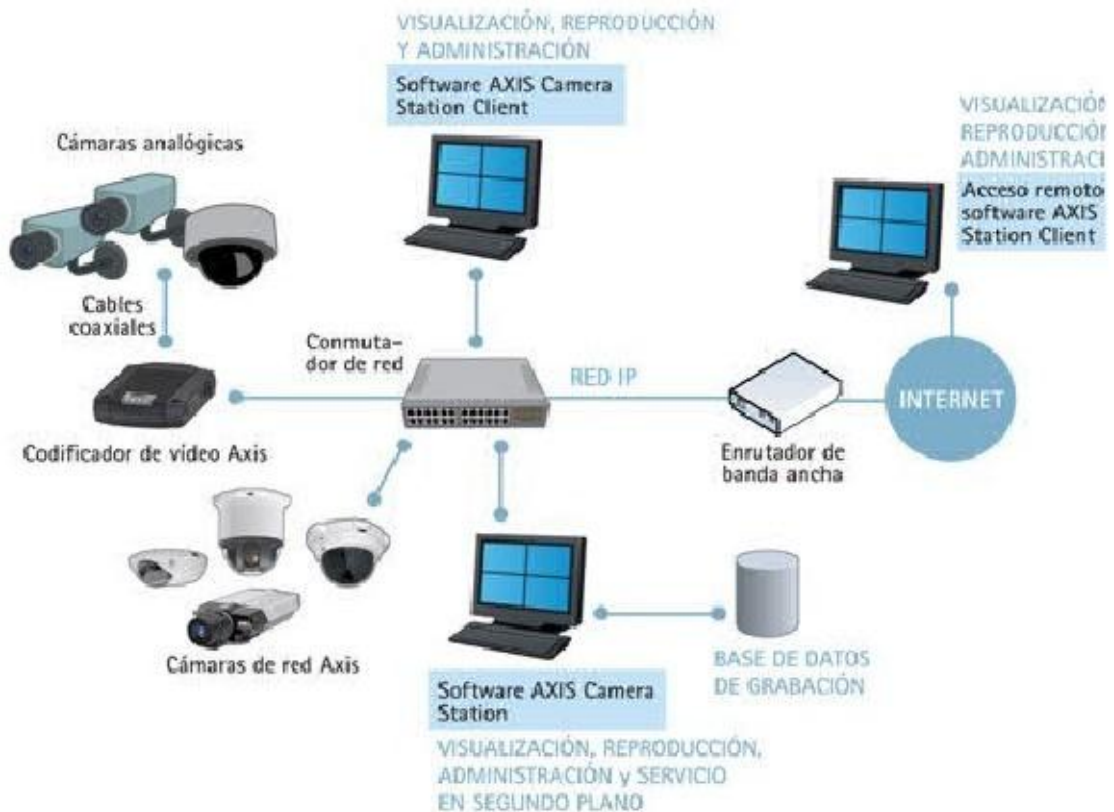
Figura.6.5. Un sistema de video vigilancia en red basada en una plataforma abierta de servidor de PC con software de ge
