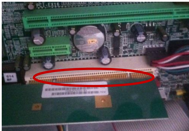
Gráfico: A.8 Fotografía en la que se evidencia una tarjeta de red inalámbrica mal colocada (Elaborado por: Investigador)
