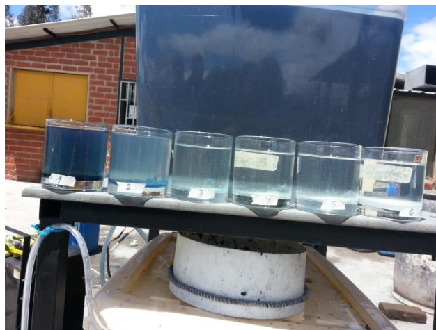
Ilustración 66.- Secuencia de clarificación del agua en subceldas Fuente: Experimentación realizada en la empresa Mundo Color
