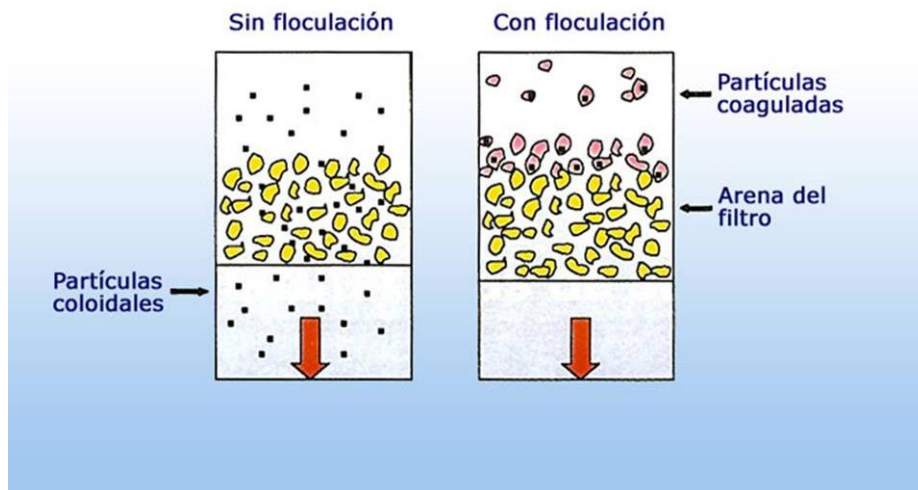
Ilustración 13.- Principio de floculación Fuente: (Díaz, 2011)
