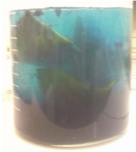
Ilustración 26.- Prueba de remoción del color con cabuya Elaborado por: Investigador
