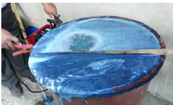
Ilustración 41.- Electrocoagulación en 100 litros Fuente: experimentación Investigador
