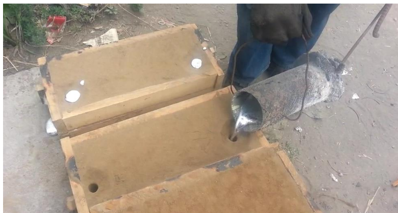
Ilustración 58.- Colado Fuente: Evidencia proceso de construcción
