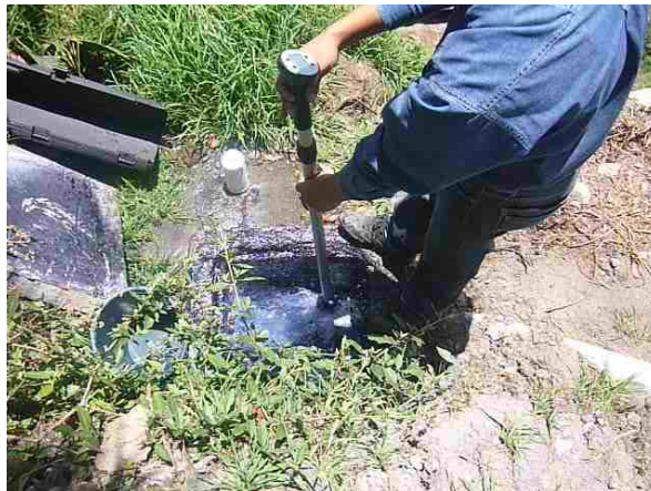
Ilustración 17.- Medición del caudal LAB. CESSTA Fuente: Punto de descarga, Empresa Mundo Color
