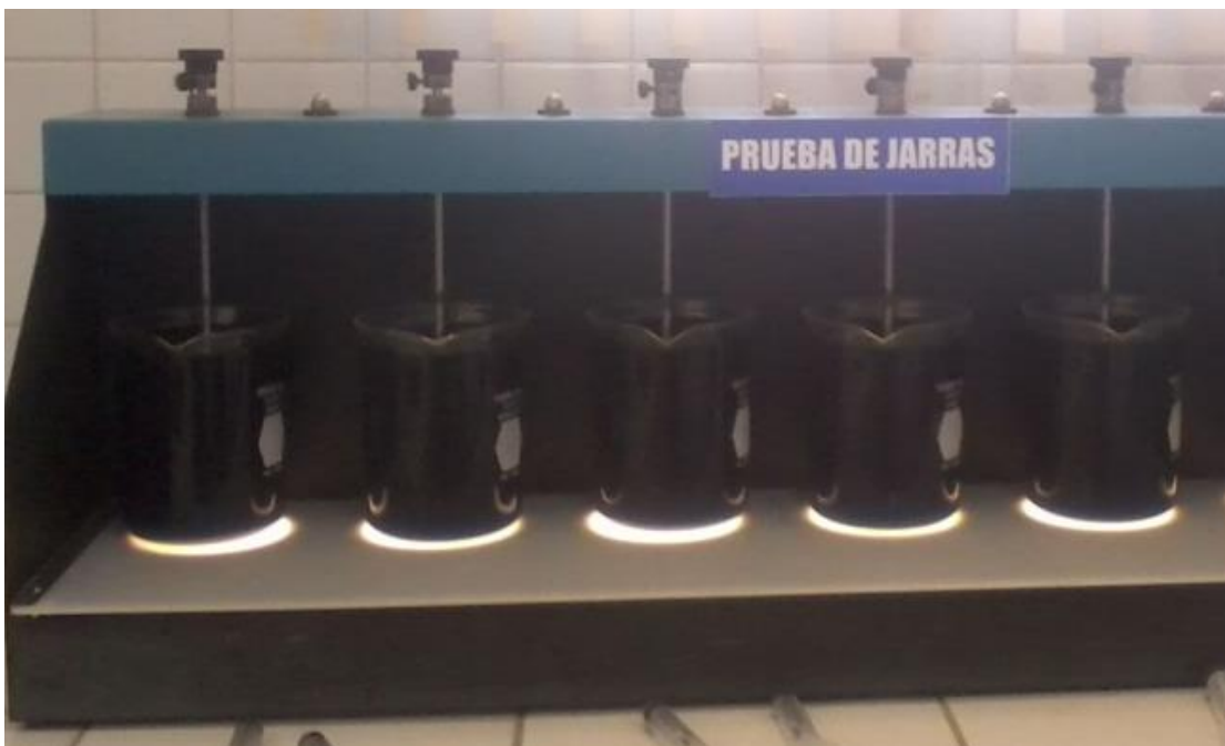
Ilustración 20.- Máquina para ensayo de prueba de jarras Fuente: Laboratorio EMAPA
