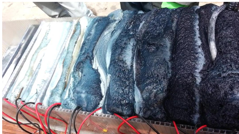
Ilustración 9.- Electro flotación de la carga contaminante Fuente: Experimentación investigador
