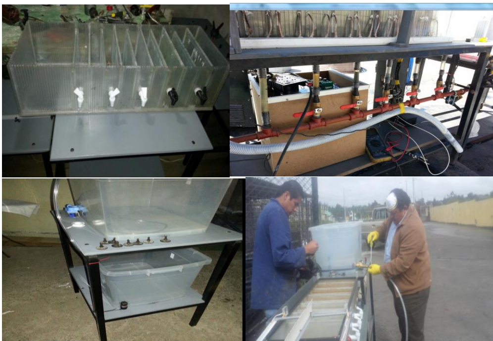
Ilustración 61.- Imágenes de la construcción del sistema de tratamiento de agua Fuente: Evidencia proceso de construcción
