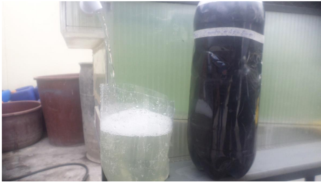
Ilustración 65.- Color antes y después del tratamiento Fuente: Experimentación en la empresa Mundo Color
