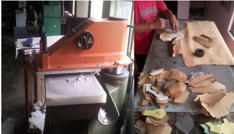
Gráfico N. 31: Corte del cuero y planta. Elaborado por: Investigador
