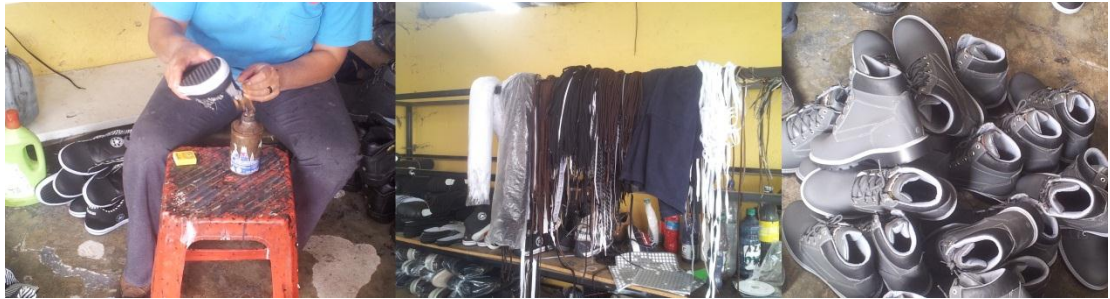
Gráfico N. 39: Retirar la horma del calzado. Elaborado por: Investigador
