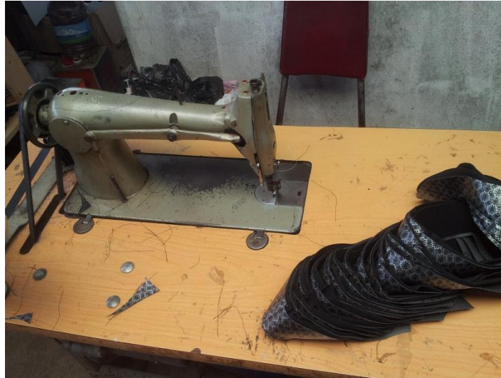
Gráfico N. 34: Aparado del calzado. Elaborado por: Investigador
