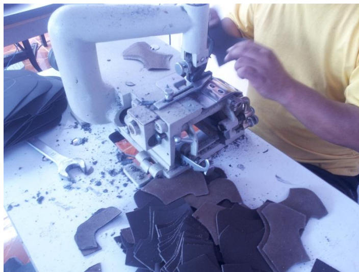
Gráfico N. 32: Corte del cuero y planta. Elaborado por: Investigador
