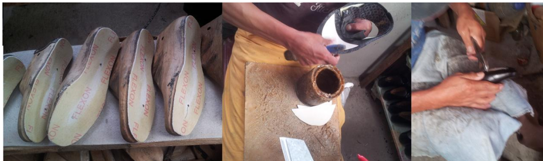
Gráfico N. 35: Armado del calzado. Elaborado por: Investigador
