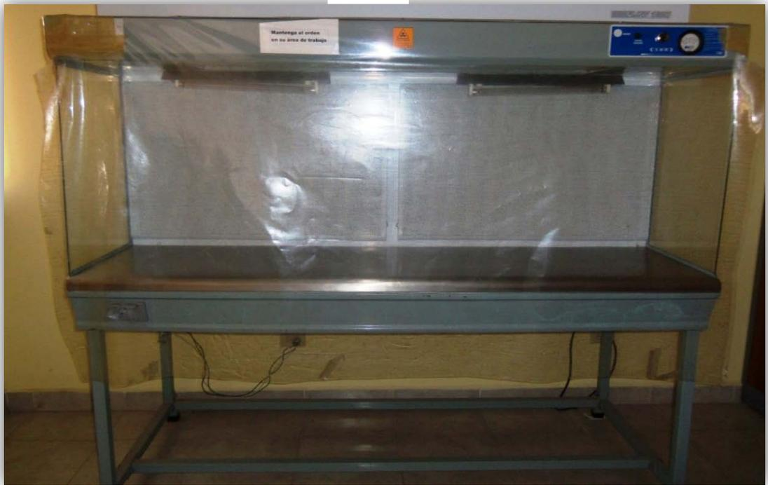
**Figura 18. Cámara de flujo laminar**
