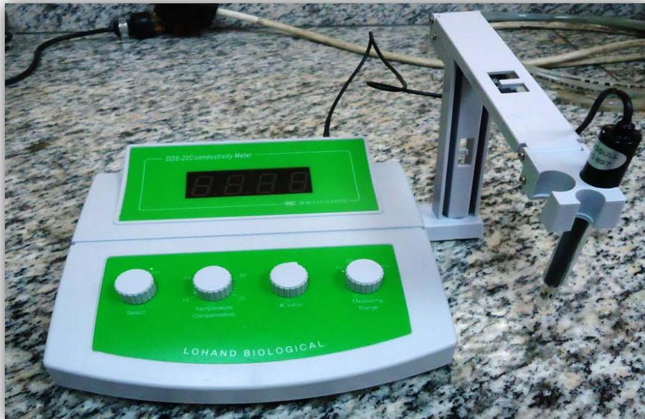
Figura 11. Medidor de Conductividad
