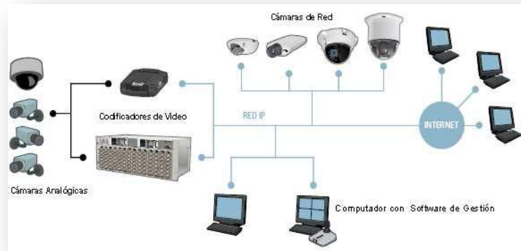
Figura 6.1 Componentes Sistema de Vigilancia IP. 27
