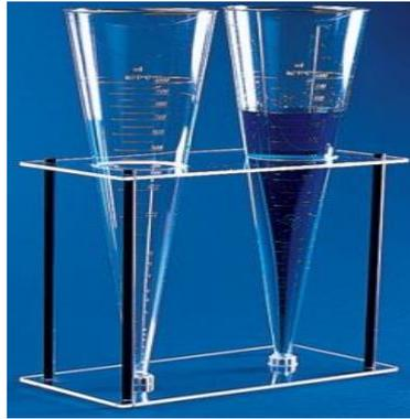
**Figura 2.14** Las partículas sólidas en el cono izquierdo son un conglomerado de materiales con partículas de tamaño diferentes. Después de asentarse durante 30 minutos se obtienen dos fracciones (cono derecho): sólidos asentables, expresados en ml/l, y turbidez, expresada en unidades nefelométricas
