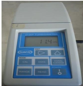
**Figura 2.17** Turbidímetro empleado en el monitoreo continuo de una corriente de agua cruda para auxiliar en el control de la dosificación del coagulante. (Cortesía de HACH Chemical Company.)
