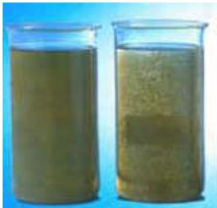
**Figura 2.11** Fotomicrografías que ilustran el proceso de coagulación. A la izquierda, agua turbia de río, que muestra la dispersión fina de partículas sólidas diminutas. A la derecha se muestra la misma agua tratada con coagulante. Las partículas están “recolectadas” en un flóculo. (130X).
