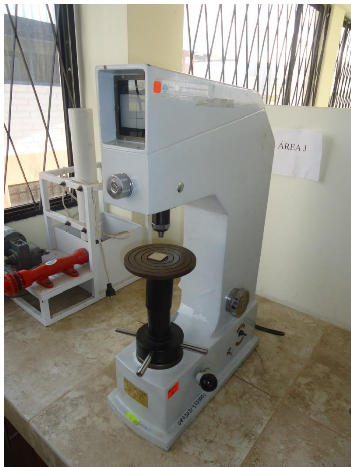
Durómetro para la aplicación de la carga
