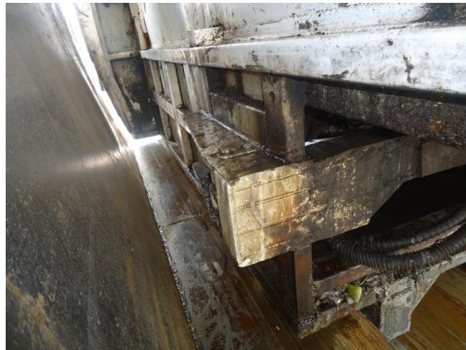
Bases inferiores de la estructura del compactador
