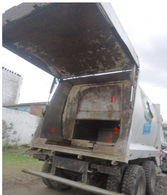
Figura 2-8: Detalle posterior del camión compactador
