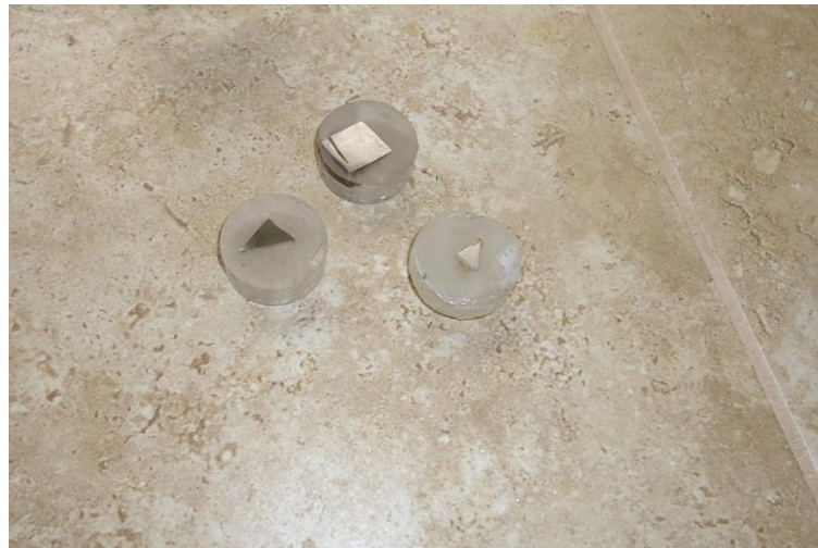
Probetas para el ensayo metalográfico
