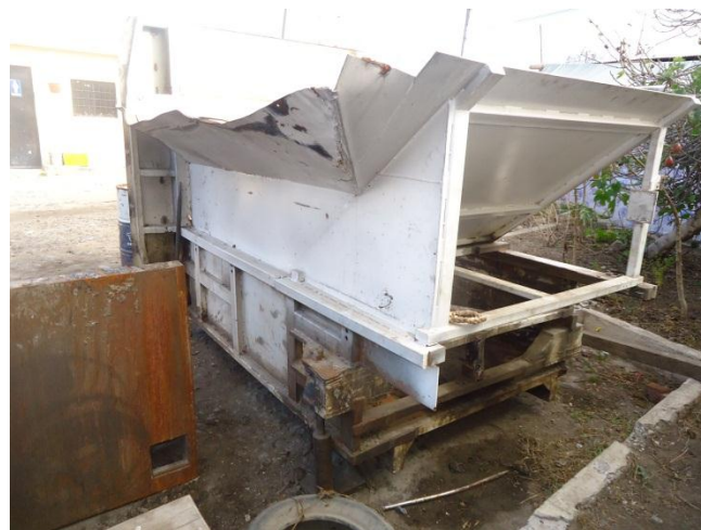
Diseño original la estructura del compactador
