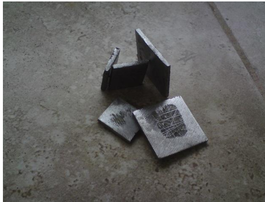
Muestras para el ensayo metalográfico y de Dureza
