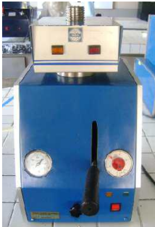
Máquina para montaje de la probeta de ensayo metalográfico.
