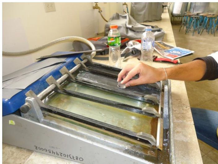
Desbaste y lijado de probetas
